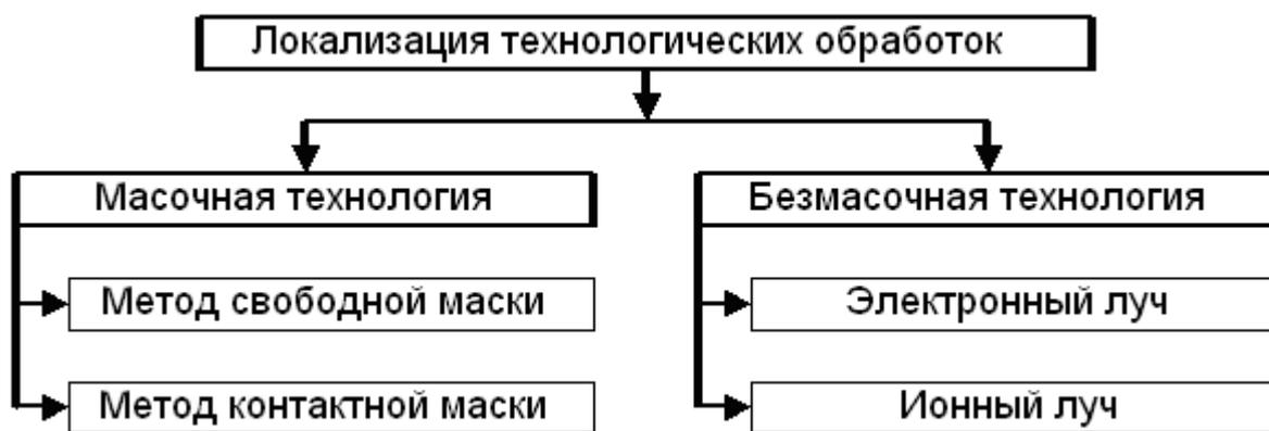
Рисунок 1.3 – Методы локализации технологических обработок при изготовлении структур ИМС
