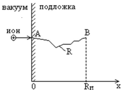
Рисунок 3.23 – К определению параметров пробега ионов.
