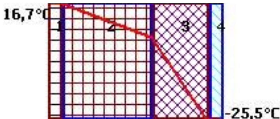
Рисунок 12 – График распределения температур в многослойной конструкции
