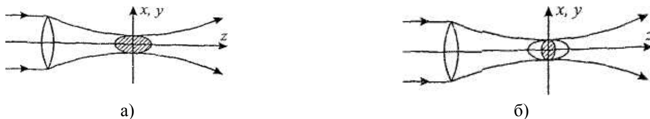
Рисунок 30 - Локализация слоя среды при фокусировке (а) и при использовании излучения малой когерентности (б)
